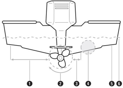
**1** Évitez les zones où il y a un écoulement d'eau turbulent. Eau turbulente se limitent normalement aux zones situées directement à l'arrière des membrures, virures ou rangées de rivets sous le bateau et dans la zone immédiate de l'hélice (des hélices). La meilleure façon de localiser un emplacement libre de turbulences est de regarder le tableau arrière lorsque le bateau se déplace.
