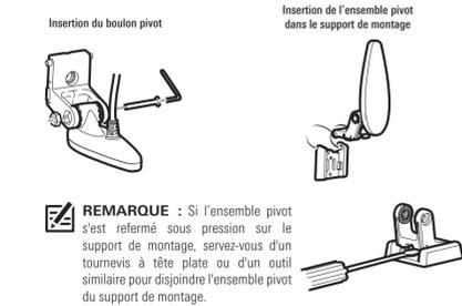
**REMARQUE** : Si l'ensemble pivot s'est fermé sous pression sur le support de montage, servez-vous d'un tournevis à tête plate ou d'un outil similaire pour disjoindre l'ensemble pivot du support de montage.
