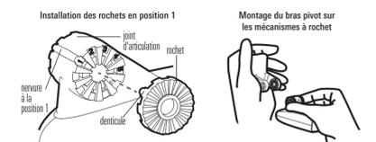
**REMARQUE** : Les mécanismes à rochet sont clavetés. Assurez-vous que les dents carrées de chaque mécanisme à rochet s'imbriquent dans celles du joint d'articulation du transducteur et que les dents triangulaires font face vers l'extérieur.
